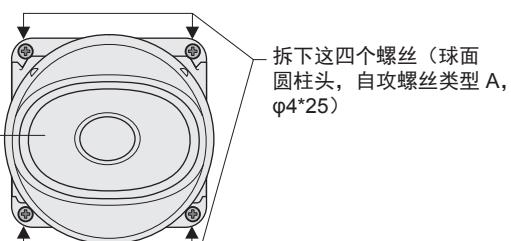
拆下这四个螺丝（球面圆柱头，自攻螺丝类型 A, φ4\*25）
