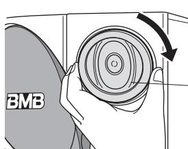
用手按下高音扬声器的突出部分的同时使其旋转。
